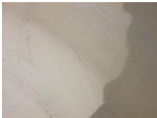
Рис. 1,2 Трещина внутренней колбы в результате транспортировки в условиях низкой температуры (менее: – 15 °C).
