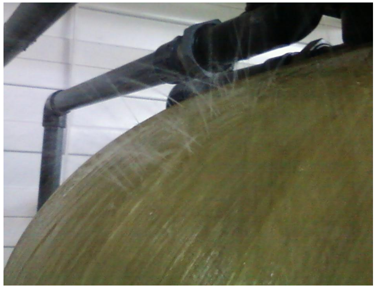
Рис. 3,4 Последствия образования трещины внутренней колбы.
